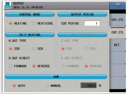
Fig. 86) Control output (Heating)
